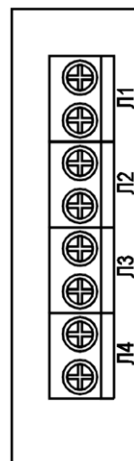
Рисунок 1.5 - Расположение колодок зажимов на плате коммутатора
